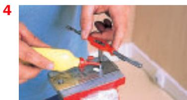
6. Remplacer le taraud ébaucheur par le taraud intermédiaire, et procéder de la même façon. Veiller à le visser parfaitement dans le filetage commencé par le taraud ébaucheur.
