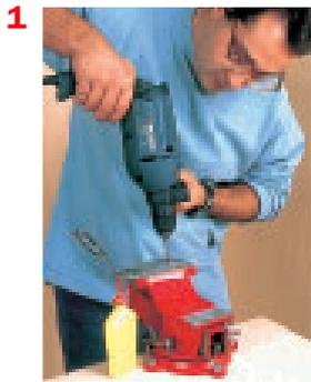
1. Percer le trou de taraudage avec un foret de diamètre correspondant aux tarauds choisis. Déposer un peu d'huile de coupe pour faciliter le perçage.
