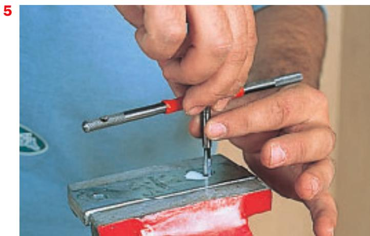
7. Terminer avec le taraud de finition et nettoyer le filetage au pétrole.
