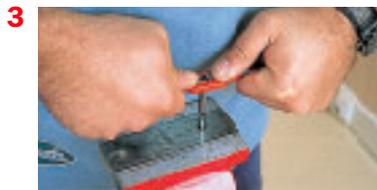
4. Visser le taraud sur une profondeur de 1 cm en déposant un peu d'huile de coupe. Revisser le taraud et, par étapes, tarauder jusqu'au bout.
