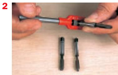
2. Serrer le taraud ébaucheur (le plus conique) dans le tourne-à-gauche.
